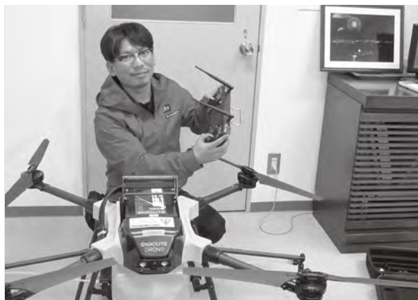
「ドローンの四方についているノズルで農薬を撒いていく。農業の高齢化が進む中、ドローンが活躍する分野は広がる」と話す中村さん
