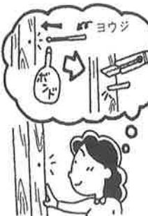
柱の穴と同じ様に気になるのが、部屋の壁のひびや穴です。補修部分に霧吹きをして湿らせ、竹べらか木べ
